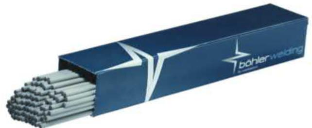
Niedriggekohlte, kerndrahtlegierte, austenitische Stabelektrode mit rutilbasischer Umhüllung. Anwendung in allen Industriezweigen, wo artgleiche Stähle, auch höhergekohlte sowie ferritische 13%-Chromstähle verschweißt werden. Besondere Schönschweißseigenschaften, exzellente Wechselstromverschweißbarkeit und eine hohe Heißrissicherheit des Schweißgutes zeichnen dieses Produkt aus.
