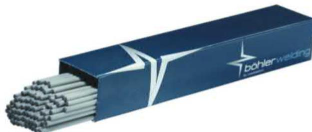
Niedriggekohlte, kerndrahtlegierte, austenitische Stabelektrode mit rutilbasischer Umhüllung. Anwendung in allen Industriezweigen, wo artgleiche Stähle, auch höhergekohlte sowie ferritische 13%-Chromstähle verschweißt werden. Besondere Schönschweißigenschaften, exzellente Wechselstromverschweißbarkeit und eine hohe Heißrissicherheit des Schweißgutes zeichnen dieses Produkt aus.
