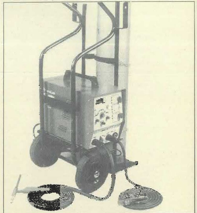
Abb. 28 Transtig 200 als WIG/TIG-Schweißanlage bestehend aus: Stromquelle, Handschweißbrenner und Massekabel, Gasflasche mit Druckminderer (Fahrgestell wahlweise)
